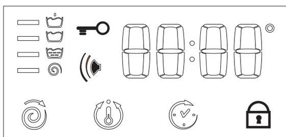
При нажатии кнопки ПУСК/СБРОС (Start/Reset) для запуска программы на дисплее показывается приблизительное время, остающееся до завершения цикла. В случае установки отложенного старта программы (пуск по таймеру, см. с. 7) дисплей будет показывать время, оставшееся до начала стирки.
