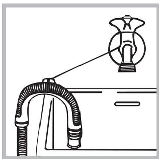
oder hängen Sie ihn in ein Becken oder eine Wanne ein; befestigen Sie ihn in diesem Falle mittels der mitgelieferten Führung an dem Wasserhahn (siehe Abbildung). Das freie Ablaufschlauchende darf nicht unter Wasser bleiben.
