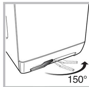
Als uw wasmachine is uitgerust met speciale in- en uitklapbare wielen, kunt u de wasmachine makkelijk verplaatsen. Om dit onderstel tevoorschijn te halen en de machine zonder moeite te kunnen verplaatsen, trekt u aan de hendel links onder
