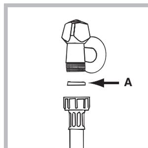
1. Вставьте прокладку А в конец заливного шланга и наведите его на вывод водопровода холодной воды с резьбовым отверстием 3/4 дюйма (см. рис.). Перед подсоединением откройте водопроводный кран и дайте стечь грязной воде.
