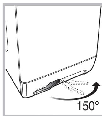
Ваша стиральная машина может быть оснащена специальными колесами для облегчения ее перемещения. Чтобы опустить колеса и передвинуть оборудование, просто потяните за рычаг, расположенный слева под основанием машины. После установки оборудования в
