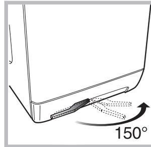
Sollte Ihr Geraet mit einem Spezialgestell mit einzieh-baren Raedern ausgestattet sein, kann das Geraet muehelos verschoben wer- den. Um dieses Gestell herunter zu lassen, ziehen Sie den links unter dem Sockel befindlichen Hebel, und versetzen dann die
