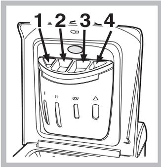
Schublade herausziehen und Waschmittel oder Zusätze wie folgt einfüllen:
