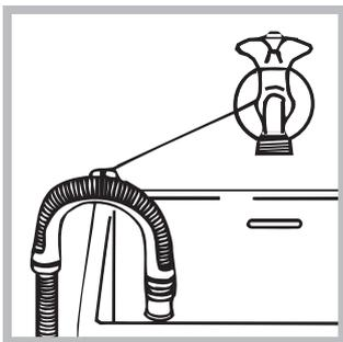
of hang hem op de rand van een wasbak of bad, en bind de bijgeleverde leiding aan de kraan (zie afbeelding). Het uiteinde van de afvoerslang mag niet onder water hangen.
