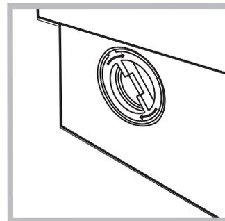
1. verwijder het paneeltje aan de voorkant van de wasmachine met behulp van een schroevendraaier (zie afbeelding);
