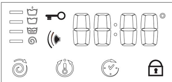
Nadat u de knop START/RESET heeft ingedrukt voor het starten van het programma ziet u op de display de tijd die resteert tot aan het einde van het wasprogramma. Als u een uitgestelde start heeft ingesteld (Uitgestelde start, zie blz. 31) wordt deze getoond.
