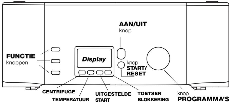
**Display** voor het programmeren van de wasmachine en voor het volgen van de voortgang van het wasprogramma (zie blz. hiernaast).
