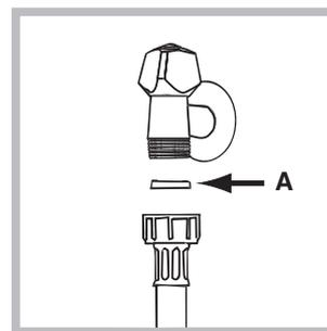
1. Plaats de pakking A op het uiteinde van de waterslang en schroef hem op een koudwaterkraan met een mondstuk met schroefdraad van 3/4 gas (zie afbeelding).
