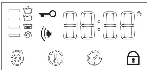
Nach Drücken der Taste START/RESET, durch das das Waschprogramm in Gang gesetzt wird, wird auf dem Display die bis zum Ende des Waschgangs noch verbleibende Zeit angezeigt. Sollte ein zeitverschobener Start eingestellt worden sein („Startvorwahl“, *siehe Seite 19*), dann wird dies auf dem Display angezeigt.
